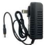
SSS-AC01 バッテリー充電用 ACアダプター
